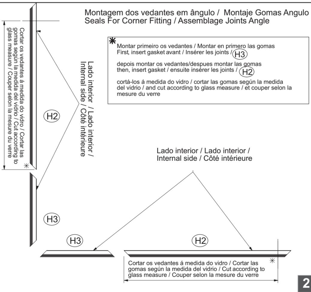
Montagem dos vedantes entre paredes / Montaje gomas entre paredes /
