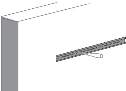
**Fixar a calha metálica na parede.**
