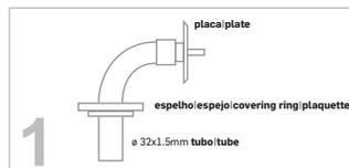
Inserir os espelhos na barra de apoio e fixar a extremidade da placa para a fixação à parede (com os parafusos incluídos na embalagem).
