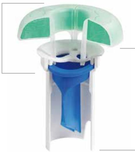
Ao passar pela válvula, o fluido provoca a abertura instantânea do diafragma vertical, sendo conduzido, sem descarga de água, para a canalização. O diafragma fecha por vácuo quando o líquido deixa de circular, impedindo o refluxo.
